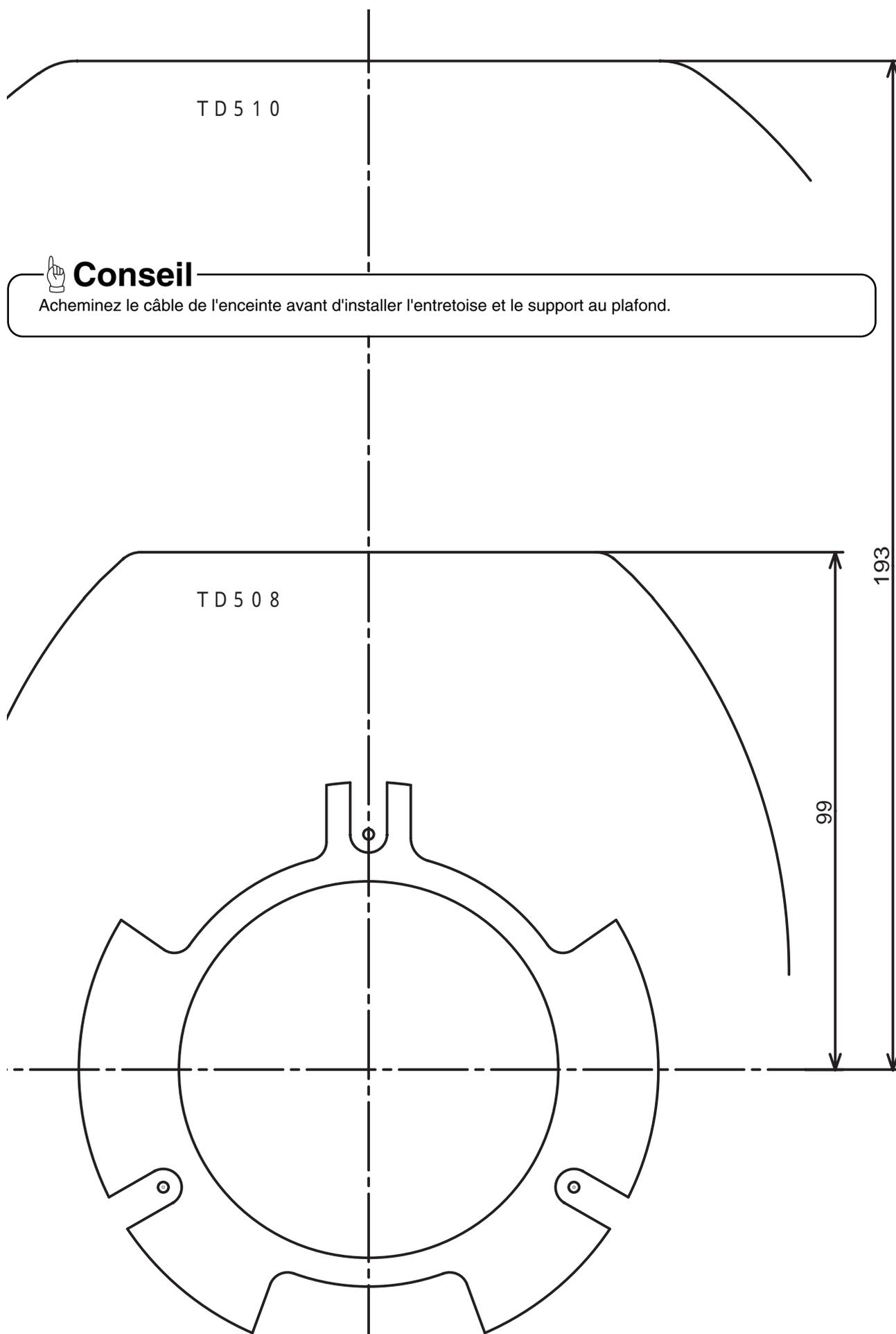
(Diamètre des trous d'installation du support: 7 mm)
